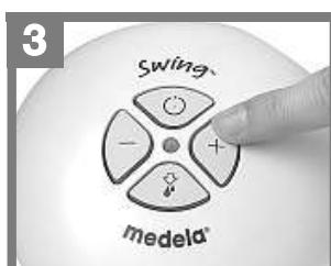
Pomocí tlačítek (+) a (-) regulujte intenzitu vakua při odsávání. Podržením tlačítka dochází k rychlejší změně intenzity vakua.
